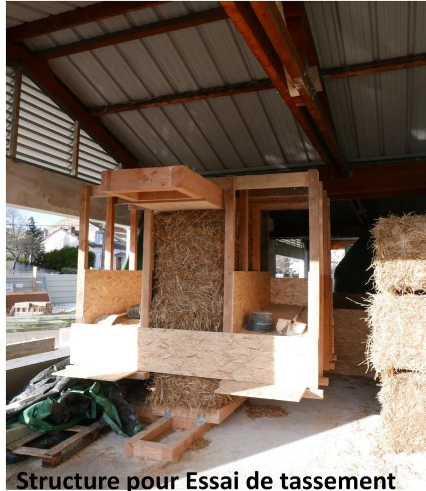
Structure pour Essai de tassement sur chantier
