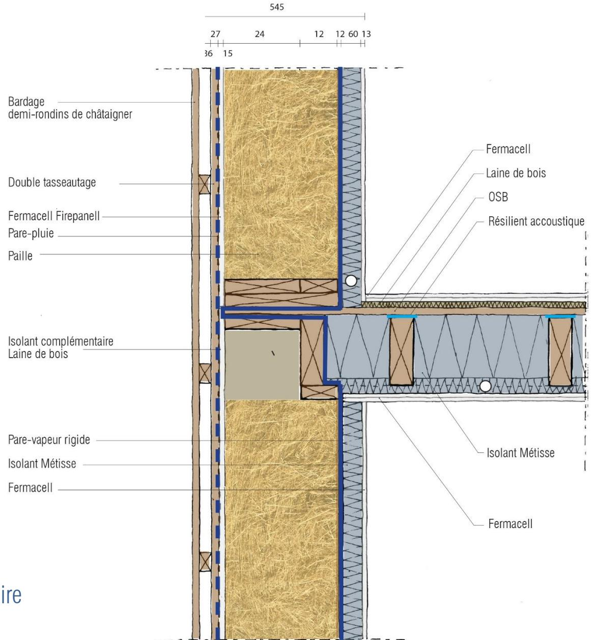
Détail ossature / plancher intermédiaire
