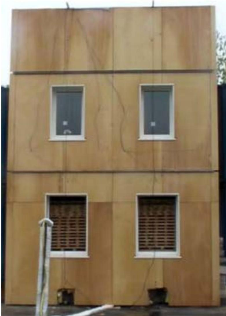
Bardage en panneaux de contreplaqués B-s2, d0 d'épaisseur 18 mis en œuvre à joints fermés sur support de bardage en bois de section 25 x 60
