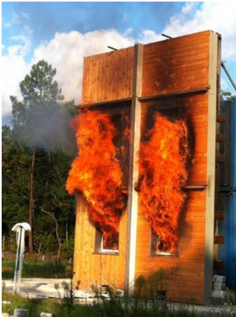
Bardage en lames de Douglas horizontales (façade droite) et verticale (façade gauche) de section 27 x 170 et support de bardage en bois de section 25 x 60
