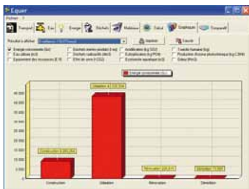
Figure 46 - EQUER - ACV bâtiment exprimée sur les différentes phases du cycle de vie
